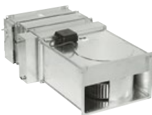
krátka zostava – klapka, filter G4, 2ř. vodné ohrievač, celková dĺžka zostavy je 1 520mm
