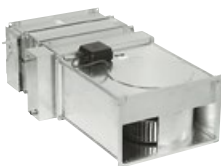
krátka zostava – klapka, filter G4, 2ř. vodné ohrievač, celková dĺžka zostavy je 1420mm
