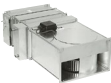
krátka zostava – klapka, filter G4, 2ř. vodné ohrievač, celková dĺžka zostavy je 1 070mm
