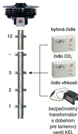
schéma zapojenia trvalého a nárazového vetrania pre CTB s časovým spínačom DT 8-R
